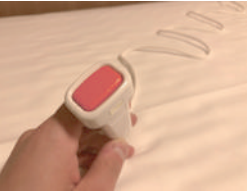
緊急通報ボタン
